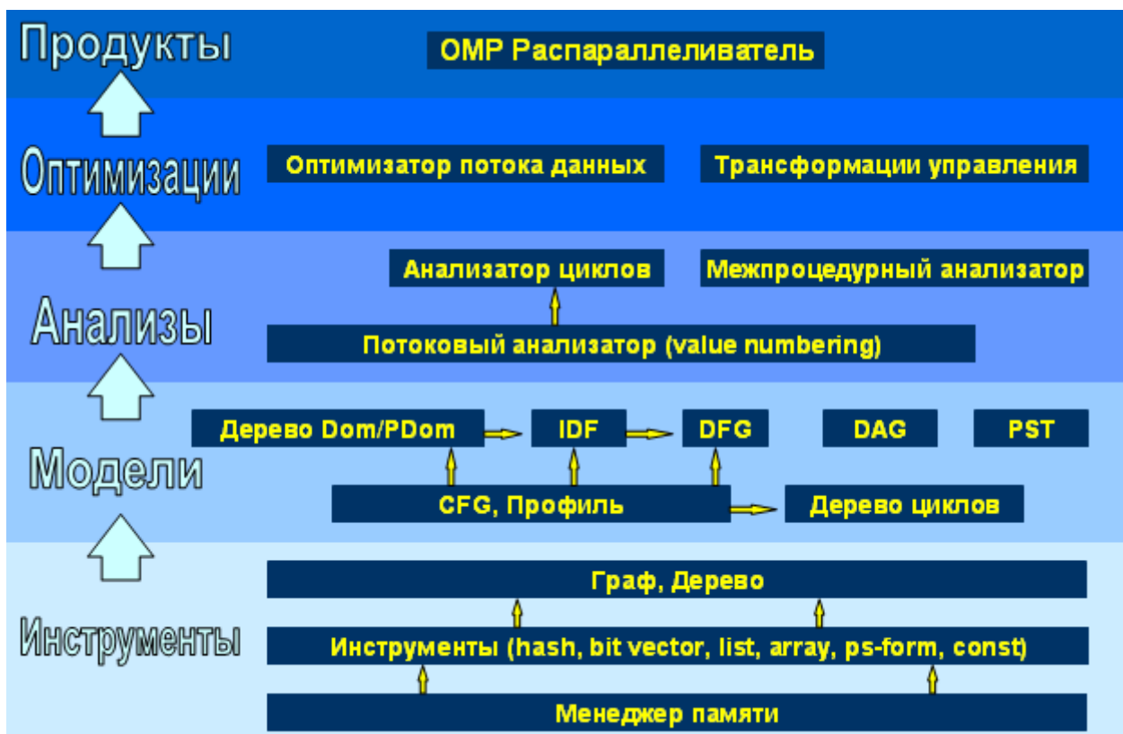
Рис. 9. Иерархия блоков оптимизирующей компиляции
